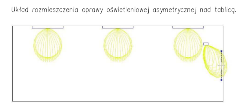
Układ rozmieszczenia oprawy oświetleniowej asymetrycznej nad tablicą.
